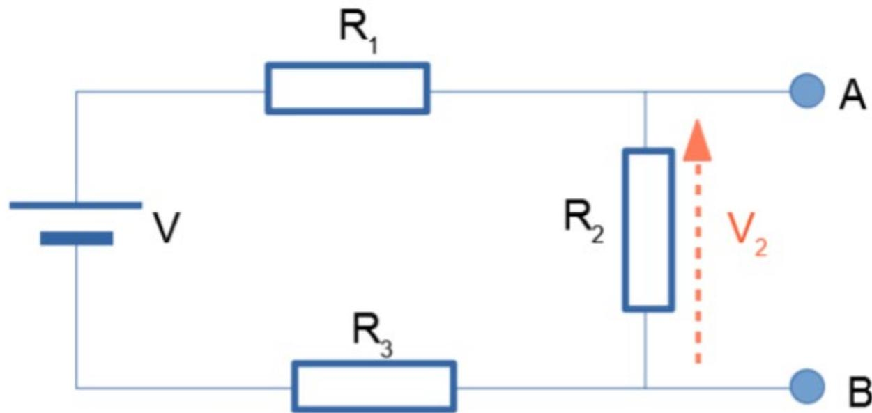
El objetivo en esta sección será calcular nominalmente el valor de  $V_2$  y, luego, simular el circuito para verificarlo.
