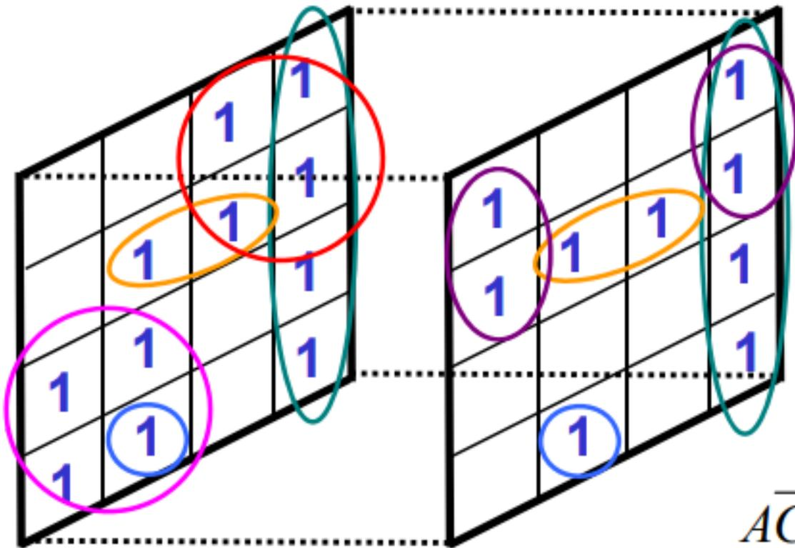
$$\underline{\overline{A}\overline{C}\overline{E}} + \underline{\overline{A}\overline{D}\overline{E}} + \underline{\overline{A}\overline{D}\overline{E}} + \underline{\overline{C}\overline{D}} + \underline{\overline{A}\overline{B}\overline{D}} + \underline{\overline{A}\overline{B}\overline{C}\overline{D}}$$
